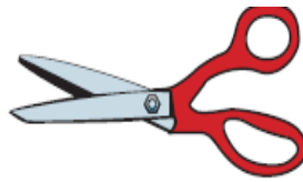
Makas; iki kama ve iki kaldıraçtan oluşan bileşik makinedir.
