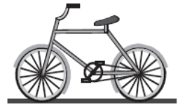
Bisiklet; tekerlek, dişli çark çıkırık ve kaldıraçtan oluşan bir bileşik makinedir.
